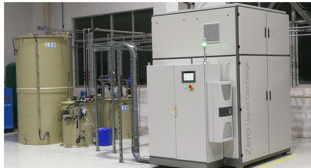
我们在不失功能的前提下，将所有部件集成在一个模块中，体积较传统蒸发器小了60%-70%，而且可实现高度自动化。
