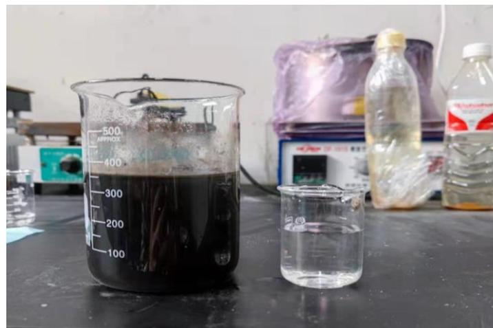
机加工冲洗废水蒸发前后对比图
